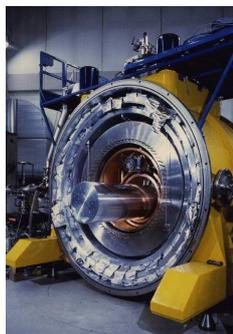
Die ersten Versuche unternahm Ende der 60er Jahre Joseph Weber. Er verwendete große Aluminiumzylinder mit Massen von ca. 1,5 Tonnen. Läuft eine Gravitationswelle längs durch diesen Zylinder, so regt sie ihn zu Schwingungen bei seiner Eigenfrequenz an. Die dadurch erzeugten Änderungen in der Länge des Zylinders werden durch hochempfindliche Verstärker gemessen
